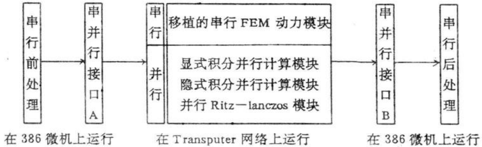
图 2 串并行混合有限元结构动力分析软件 PFEM 系统结构
