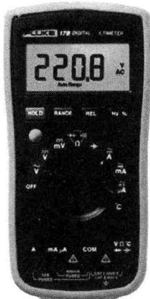
图 1.2.3 Fluke 17B 数字万用表外观
