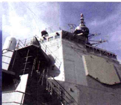
舰载“宙斯盾”系统的相控阵雷达天线
