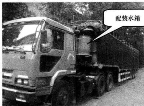
图 1-2 装载冷却制动鼓水箱的重型货车
