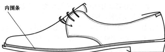
图 0-4 硫化工艺内围条鞋底的结构
