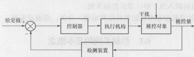
图 0-2 闭环控制系统原理结构图
