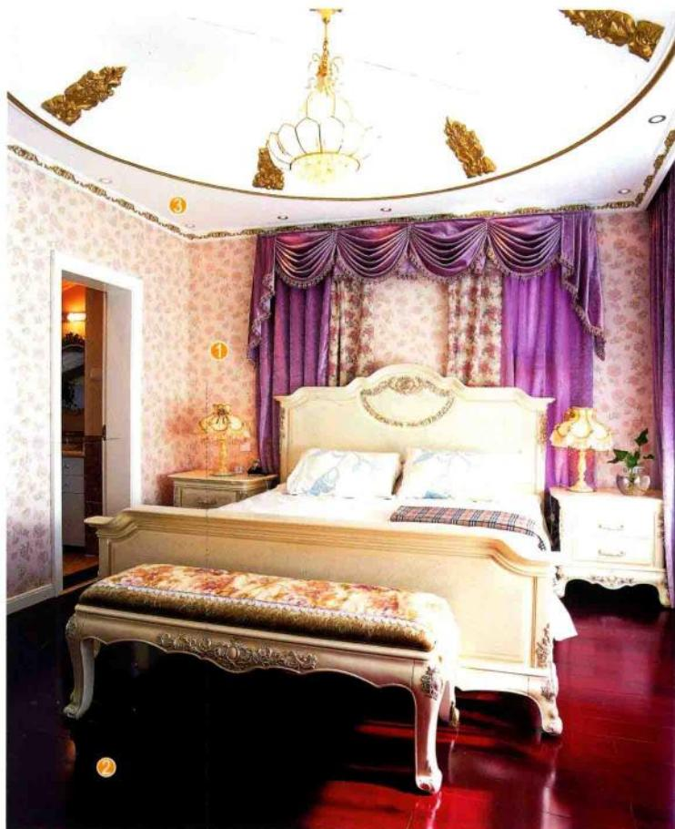
床头背景墙面先用水泥砂浆找平，后满刮腻子，用砂纸打磨光滑，刷一层基膜，用环保白乳胶配合专业壁纸粉将壁纸固定在墙面上，安装踢脚线，固定装饰窗帘。
