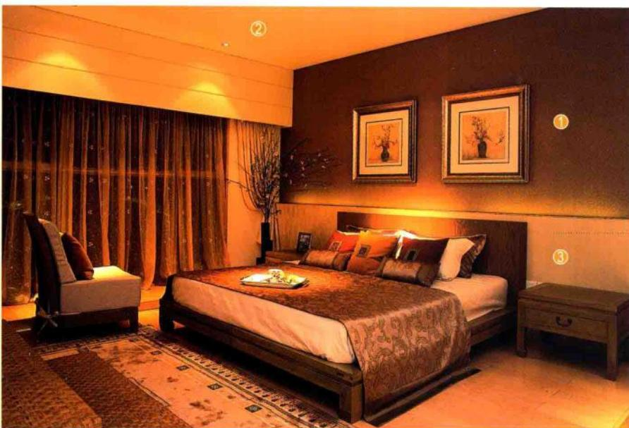
床头背景墙面用水泥砂浆找平，满刮三遍腻子，用砂纸打磨光滑，固定成品窗套，刷底漆、面漆。部分墙面刷一层基膜，用环保白乳胶配合专业壁纸粉将壁纸固定在墙面上。最后安装踢脚线。
