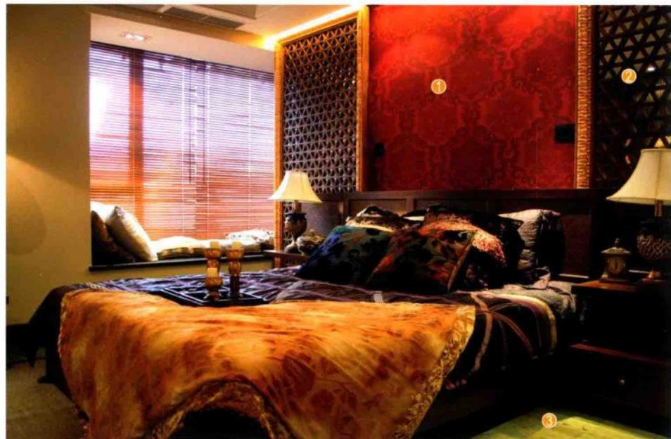
床头背景墙两侧用木工板打底，中间墙面满刮腻子，用砂纸打磨光滑，刷一层基膜后贴壁纸。用粘贴固定的方式将银镜固定在底板上，再将订制的通花板固定在墙面上。
