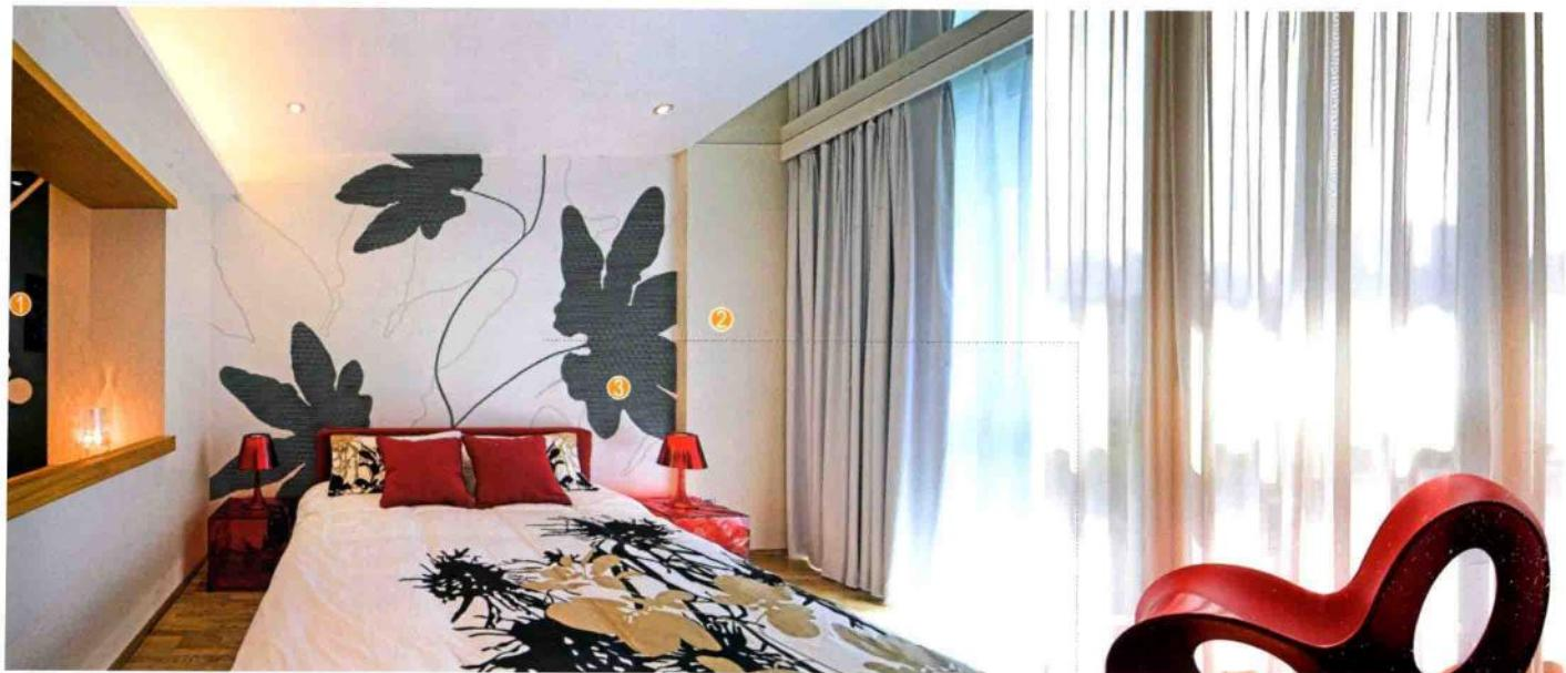
背景墙面满刮三遍腻子，用砂纸打磨光滑，刷底漆、面漆，安装实木踢脚线。用丙烯颜料将图案手绘到墙面上。
