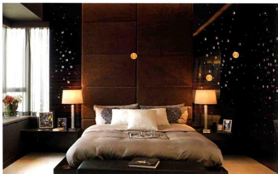
床头背景墙面用水泥沙浆找平，墙面防潮处理后用木工板打底，用气钉及万能胶固定软包，最后固定两侧的三氯氰胺板。
