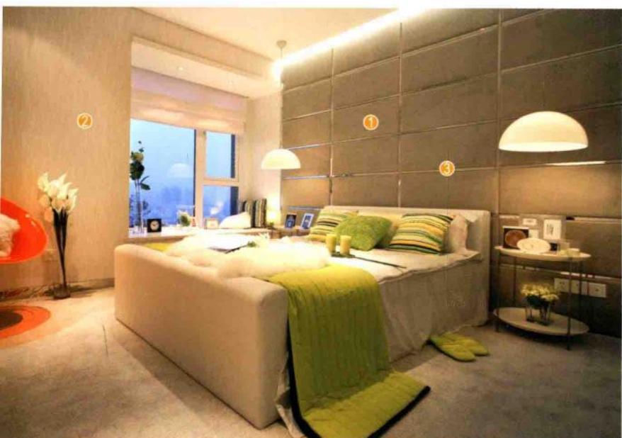
卧室床头背景墙面用水泥砂浆找平，整个墙面用木工板打底，用气钉及万能胶将订制的软包固定在底板上，固定不锈钢收边线条。
