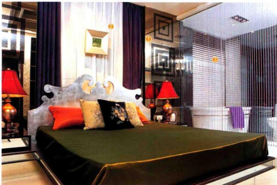
床头背景墙面用水泥砂浆找平，两侧用木工板打底，剩余墙面满刮腻子，用砂纸打磨光滑，刷底漆、面漆。用粘贴固定的方式将茶镜固定在底板上，用密封胶密封，将订制的帷幔固定在墙上。
