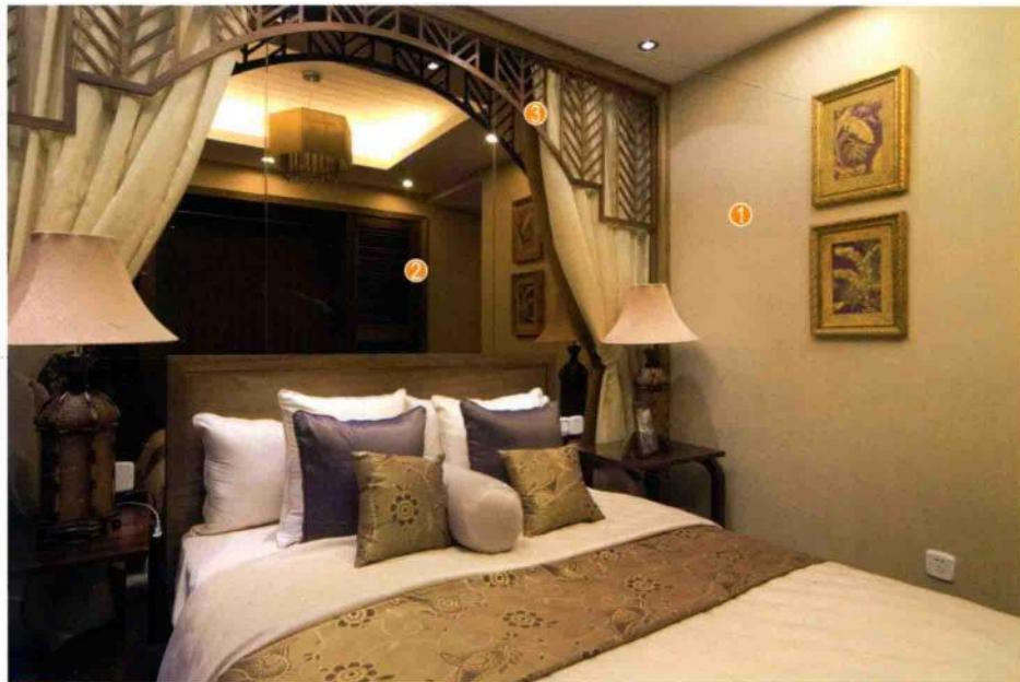
床头背景墙面用木工板打底，两侧贴装饰面板，刷油漆。用气钉及万能胶将定制的软包固定在中间底板上。
