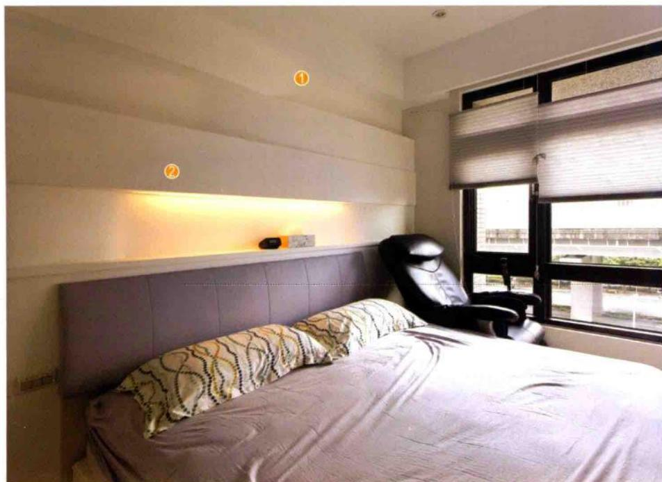
背景墙面用水泥砂浆找平，满刮腻子，用砂纸打磨光滑，刷底漆、面漆。最后安装实木踢脚线，将成品屏风靠在墙面上。
