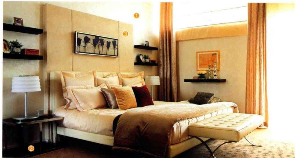
床头背景墙面用壁纸和软包装饰，软包基层用木工板打底。剩余墙面满刮腻子，用砂纸打磨光滑，刷一层基膜后贴壁纸。用气钉及万能胶将订制的软包固定在底板上。
