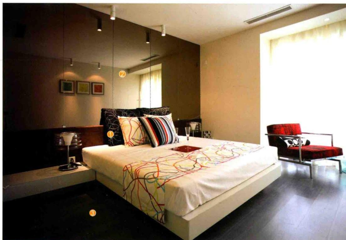
床头背景墙面用水泥砂浆找平，用木工板做出床头柜，贴装饰面板后刷油漆。剩余墙面用木工板打底，用气钉将软包固定在底板上，用粘贴固定的方式将镜面玻璃固定在底板上，用密封胶密封。
