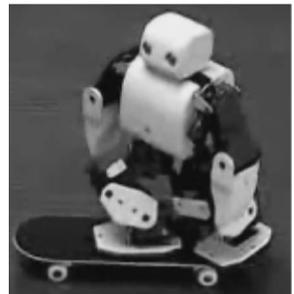
图 1-4 滑板机器人
