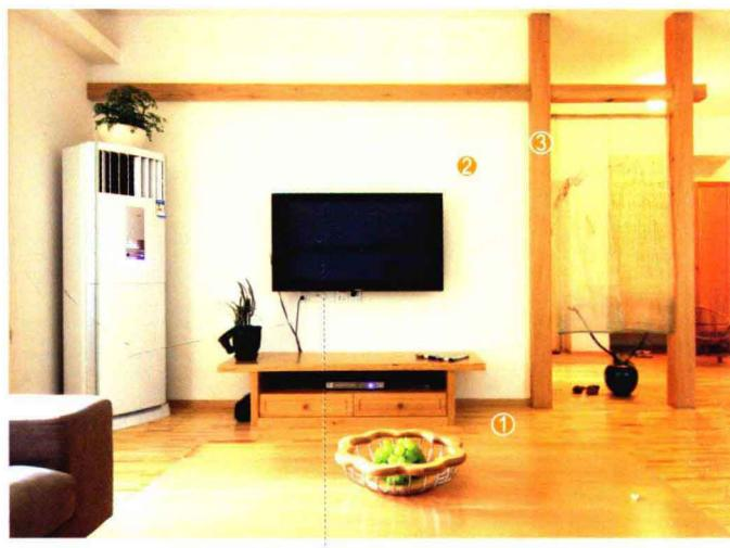
电视背景墙面用水泥砂浆找平，用木工板做出设计图中造型，贴装饰面板后刷油漆。剩余墙面满刮腻子，用砂纸打磨光滑，刷底漆、面漆。最后安装踢脚线。
