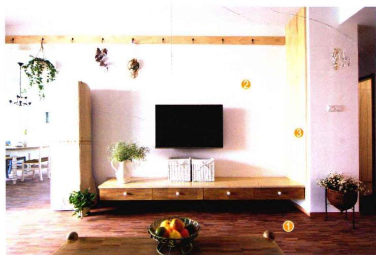
按设计图在墙面上弹线，用气钉及白乳胶将杉木板固定在墙面上，用木工板做出层板，贴装饰面板，刷油漆。剩余墙面满刮三遍腻子，用砂纸打磨光滑，刷底漆、面漆。
