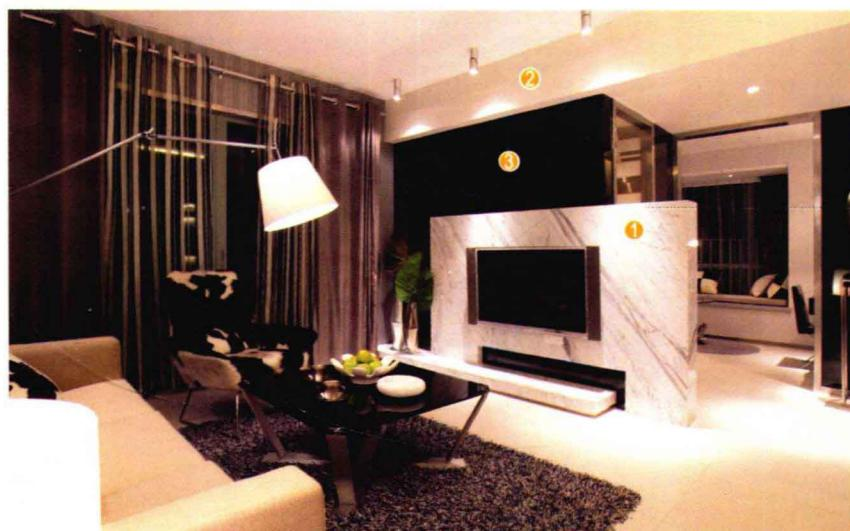
按设计图在墙面上弹线，墙面安装钢结构，用干挂的方式固定大理石，安装完毕后用专业的勾缝剂填缝；贴黑色烤漆玻璃的基层用木工板打底，用托压固定的方式将其固定。剩余墙面满刮腻子，刷底漆、面漆。
