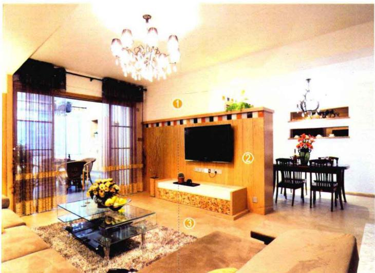
电视背景矮墙用水泥砂浆找平，用湿贴的方式固定仿古砖，剩余墙面用木工板打底，贴装饰面板后刷油漆。剩余墙面满刮腻子，用砂纸打磨光滑，刷底漆、面漆。
