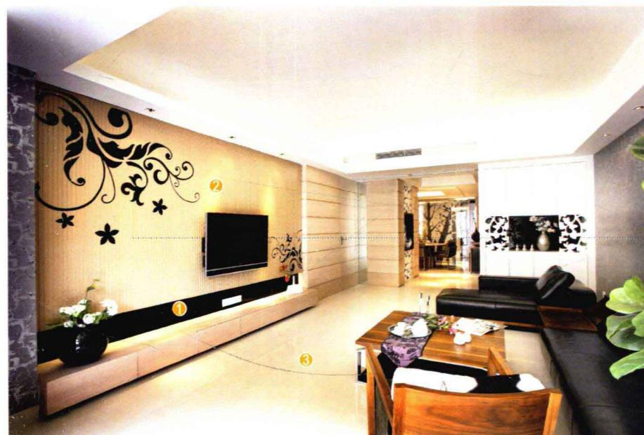
用木工板做出电视背景墙面上灯槽结构及门和电视柜造型，贴装饰面板后刷油漆，剩余墙面满刮三遍腻子，用砂纸打磨光滑，刷底漆、面漆，安装踢脚线。
