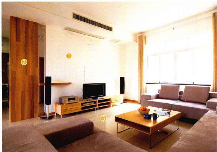
用木工板做出电视背景左侧的墙体及层板造型，贴橡木装饰面板后刷油漆。剩余墙面满刮腻子，用砂纸打磨光滑，刷底漆、面漆，最后安装踢脚线。
