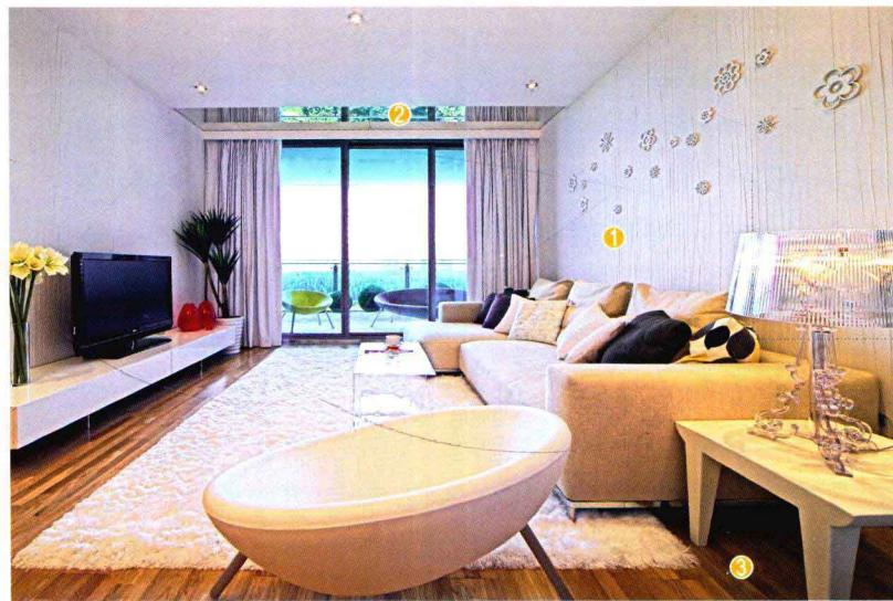
沙发背景墙面用水泥砂浆找平，用木工板做出凹凸造型，以实木线条收边，贴装饰面板后刷油漆。剩余墙面满刮腻子，用砂纸打磨光滑，刷一层基膜后贴壁纸，固定踢脚线，固定成品花格板。
