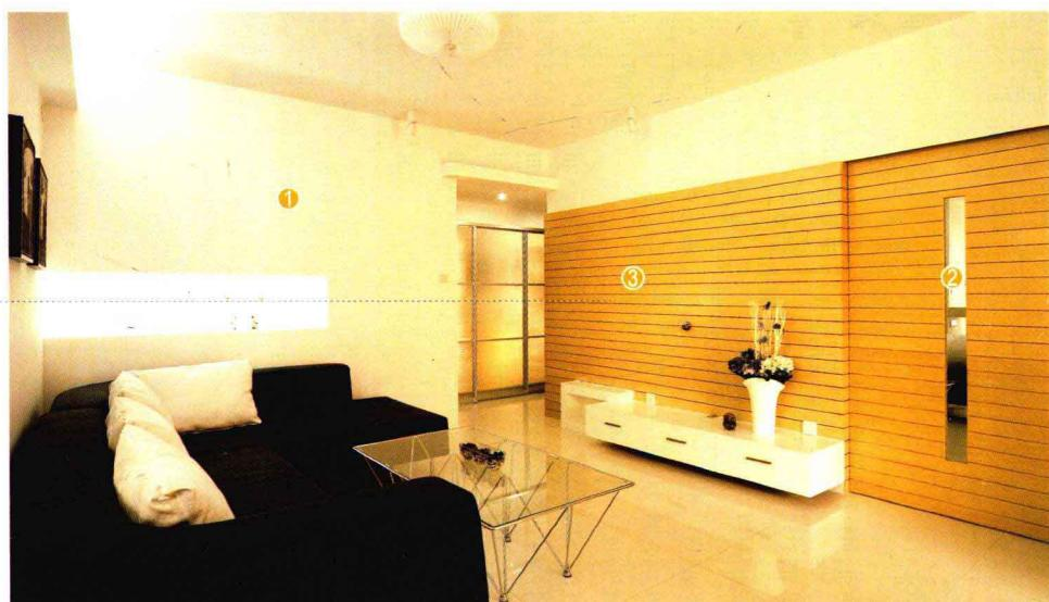
电视背景墙面用木工板打底，部分墙面及电视柜贴装饰面板后刷油漆。剩余墙面满刮三遍腻子，用砂纸打磨光滑，刷底漆、面漆。
