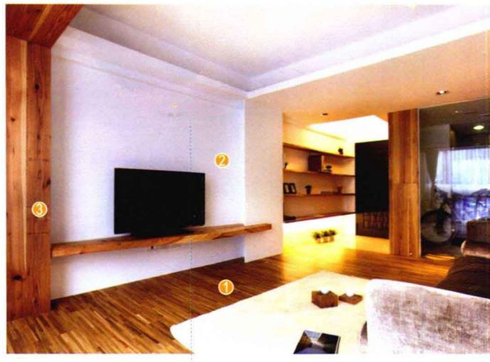
用木工板做出电视背景墙面上层板及左侧连贯到顶部的造型，贴装饰面板后刷油漆。剩余墙面满刮腻子，用砂纸打磨光滑，刷底漆、面漆。
