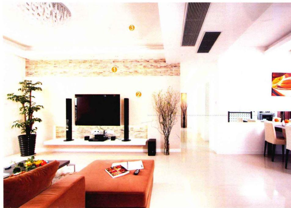
电视背景墙面用水泥砂浆找平，用湿贴的方式将文化石固定在墙面上。用木工板做出层板造型，贴装饰面板后刷油漆。剩余墙面满刮三遍腻子，刷一层基膜后贴壁纸，安装踢脚线。
