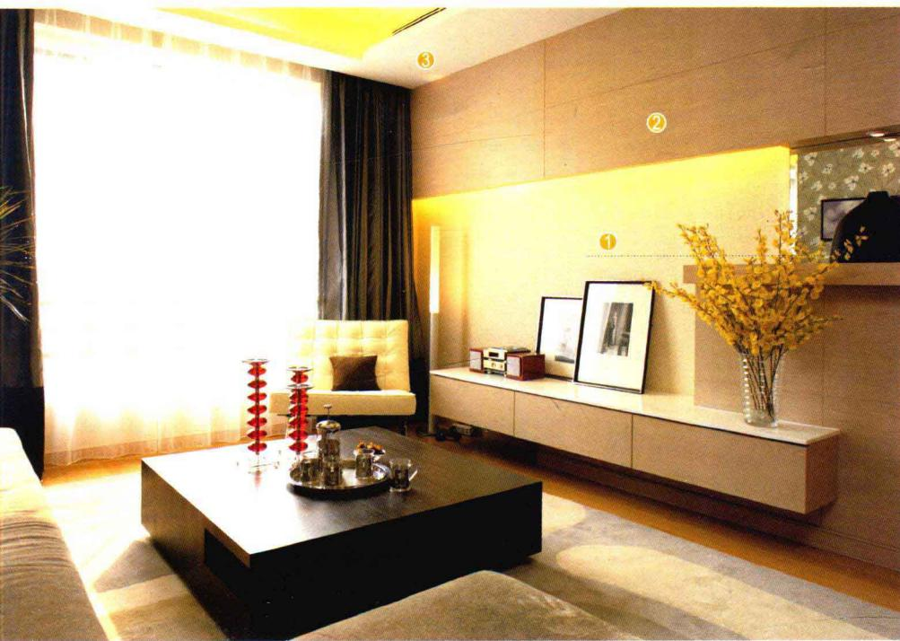
按设计需求，用木工板做出电视柜及墙面的凹凸造型，贴水曲柳饰面板后刷油漆。剩余墙面满刮腻子、用砂纸打磨光滑，刷一层基膜后贴壁纸。
