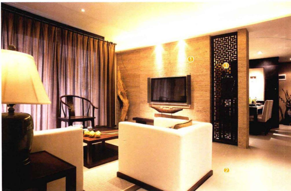
按设计图在墙面上弹线，用湿贴的方式将同规格的仿古砖固定在墙面上，完工后用勾缝剂填缝，将订制的通花板固定在预留的墙面上。
