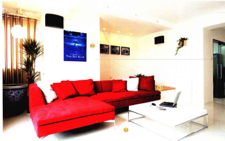
部分沙发背景墙面是在砌好的砖墙上直接刷白色水泥漆，剩余墙面满刮腻子，用砂纸打磨光滑，刷底漆、面漆。
