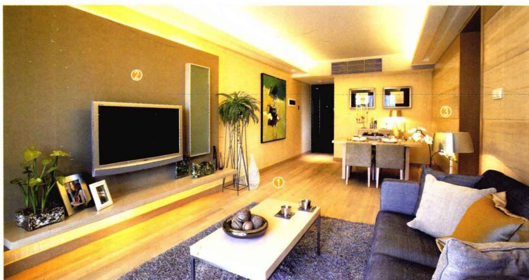
用木工板做出电视背景墙上的凹凸立体及灯带造型，层板贴装饰面板后刷油漆，剩余墙面满刮腻子，用砂纸打磨光滑，刷一层基膜后贴壁纸，最后安装踢脚线。
