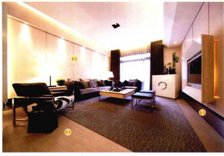
按照设计图纸，将不锈钢收边线条固定在墙面上，底部墙面用木工板打底，剩余墙面满刷三遍腻子，用砂纸打磨光滑，刷底漆、面漆，用粘贴固定的方式固定灰镜。
