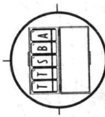
**药水盒：**金属的药水盒里有5瓶药水，需要配合喷枪（见上图）一起使用。每瓶药水都用一个单独的字母表示不同的液体：
