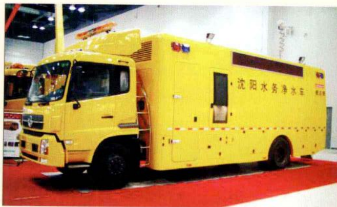
沈阳水务集团有限公司与南京南汽畅通公路机械有限公司联合开发的大出水量应急净水车
