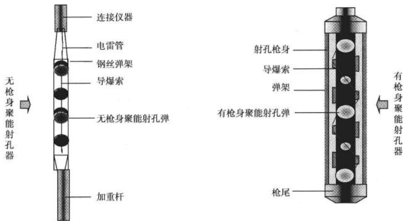
图 2-1 有枪身射孔器和无枪身射孔器
