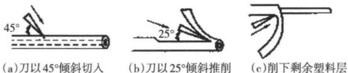
图1-1-6 电工刀剖削塑料硬线绝缘层
