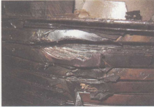
图 2-1 Am 相烧熔断股
