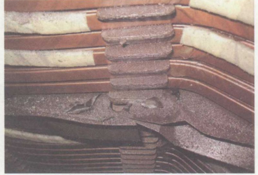
图 2-2 Am 相油道绝缘垫片上散落铜屑
