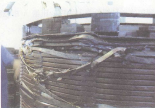
图 2-5 Cm 相断股变形
