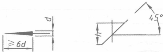
d 为粗实线宽度 (a)箭头的画法 h 为字体高度 (b)斜线的画法
