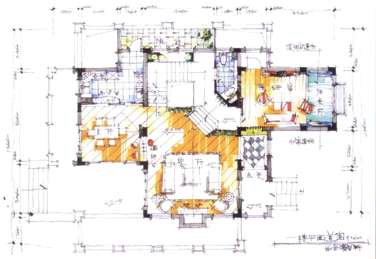
图1-4 这是设计实战中的一个手绘平面图，以清晰、明快的线条和色彩清楚地展示了设计创意，使客户能很直观地读懂设计方案。
