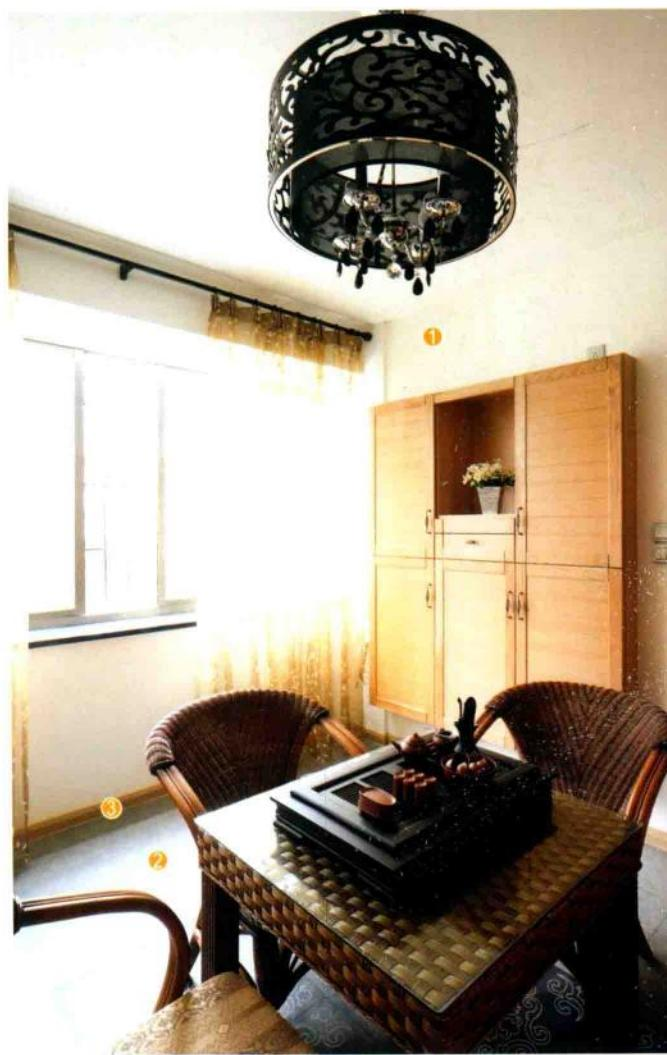
玄关墙面用水泥砂浆找平，用木工板做出储物柜造型，贴装饰面板后刷油漆。剩余墙面满刮三遍腻子，用砂纸打磨光滑，刷底漆、面漆，安装实木踢脚线。
