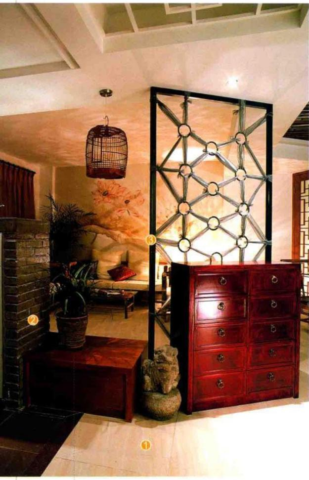
玄关矮台用青砖砌成，清洁表面，刷清漆。用木工板做出矮柜，贴装饰面板后刷油漆，最后用螺钉固定黑铁架。
