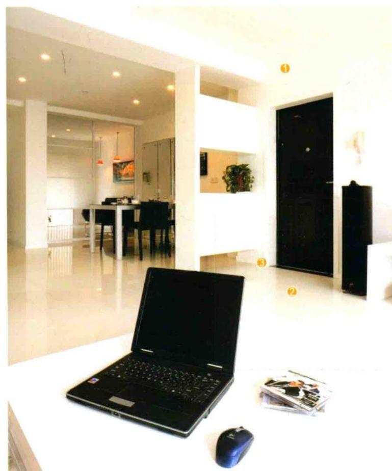
用木工板在入户处做出鞋柜造型，贴装饰面板后刷油漆。剩余顶部梁，满刮三遍腻子，用砂纸打磨光滑，刷底漆、面漆。
