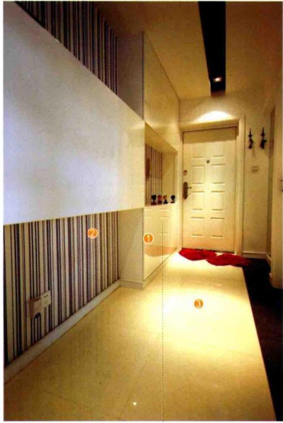
入户玄关墙面用水泥砂浆找平，用木工板做出储物柜，贴水曲柳饰面板后刷油漆。用硅酸钙板做出剩余墙面上的凹凸造型，满刮三遍腻子，用砂纸打磨光滑，刷底漆、面漆，刷一层基膜后贴壁纸，安装实木踢脚线。
