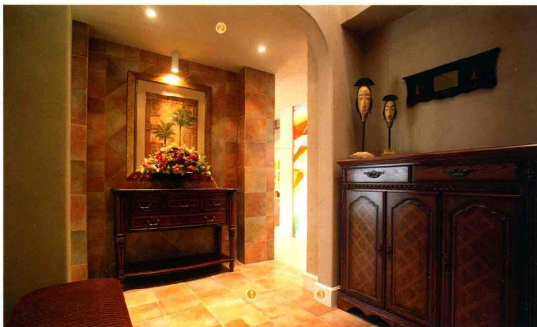
玄关端景墙面用水泥砂浆找平，用湿贴的方式将仿古砖固定在墙面上，完工后用勾缝剂填缝，清洁表面。
