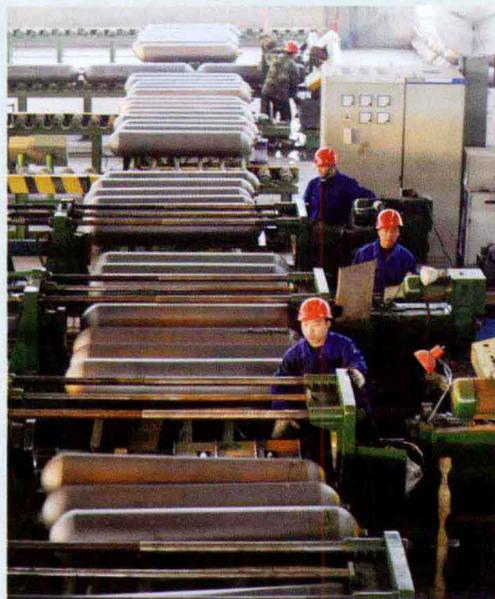
**转型升级，创新驱动，产业结构调整迈出新步伐** 2012年，河北省大力推进技术改造，全省用于技术改造、淘汰落后产能和培育新兴产业等方面的资金达到5800亿元，有力地促进了产业结构优化升级。左图：河北钢铁集团2180mm冷轧生产线采用当今国际领先的五机架六辊CVC+轧机板型控制技术，可生产高精度家电面板、轿车面板。（河北日报资料图片）右图：位于河北省邯郸经济开发区的新兴新能源设备制造基地车用压缩天然气瓶生产车间。（赵永辉 摄）
