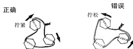
图 1-11 锁紧金属线的锁紧
