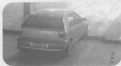
图 1.8 汽车在制动试验台上作制 动性能测试
