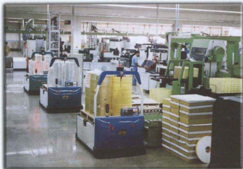
▲能灵巧驶入机台的推挽式激光导引无人运输车
