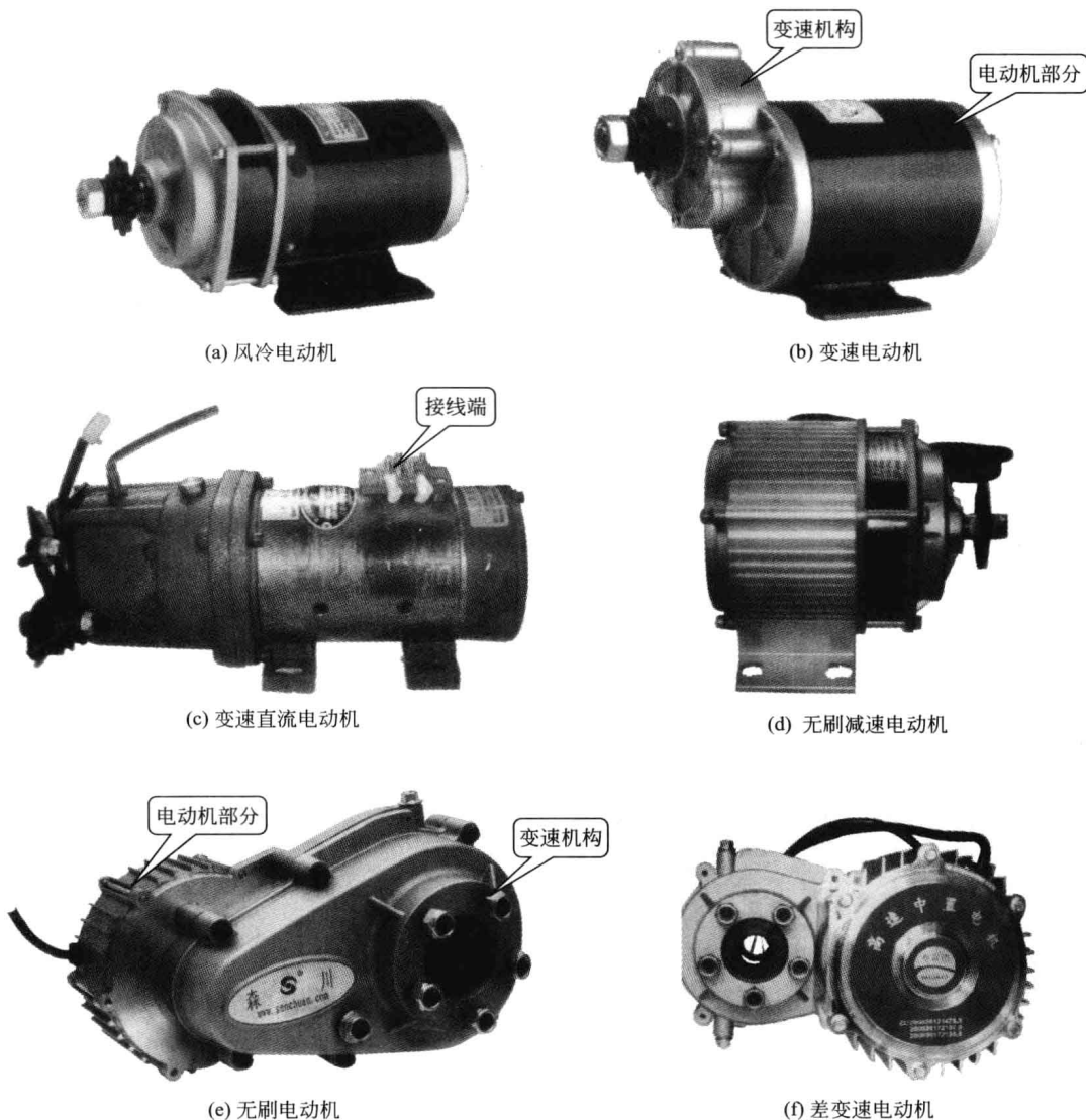
图 1-7 电动三轮车电动机的结构
