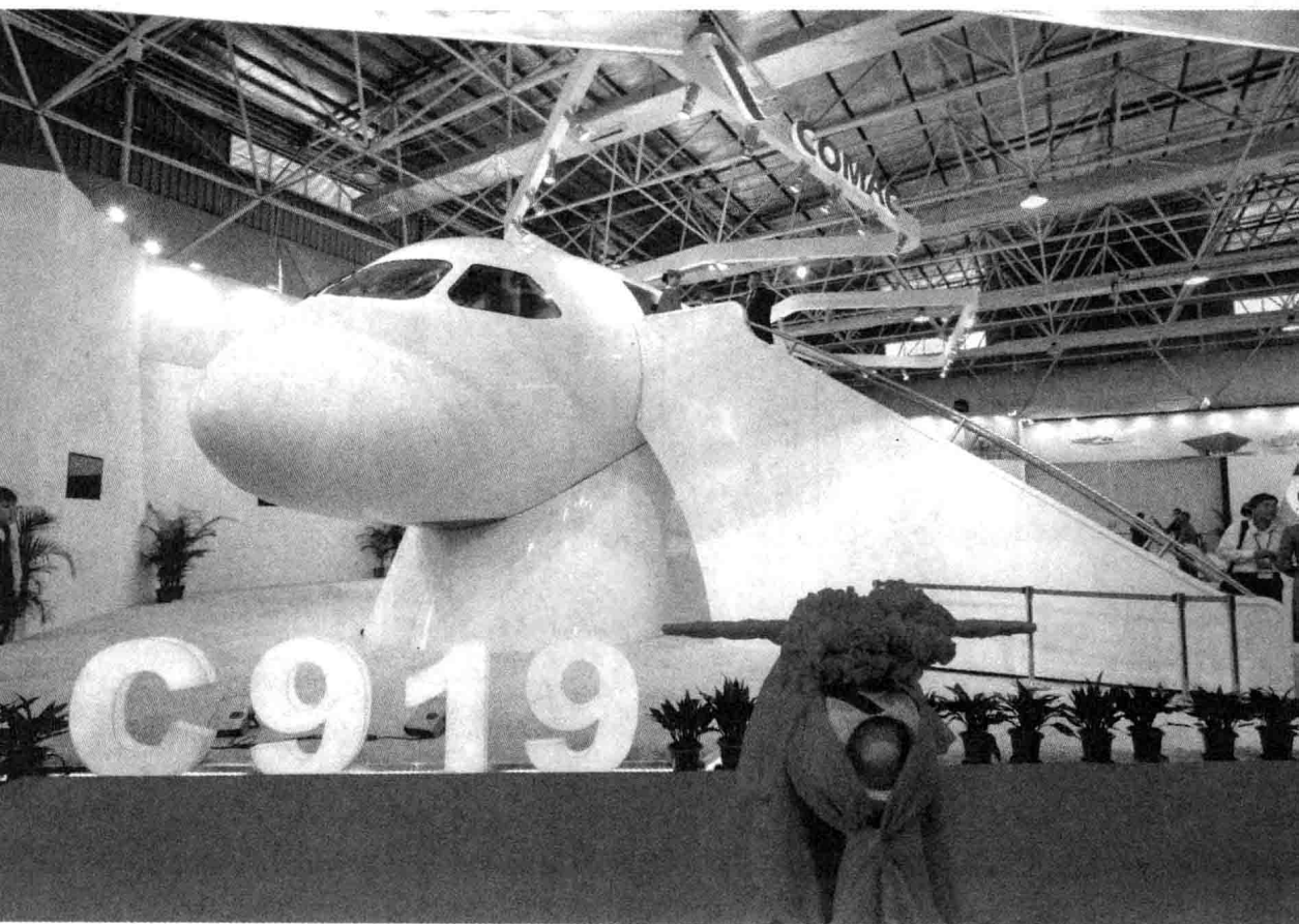
2010年11月15日，C919大型客机1:1展示样机在珠海航展亮相。飞机采用常规布局形式，后掠下单机翼、左右机翼下各安装一台高涵道比涡轮风扇发动机、正常式尾翼及前三点可收放式起落架。
