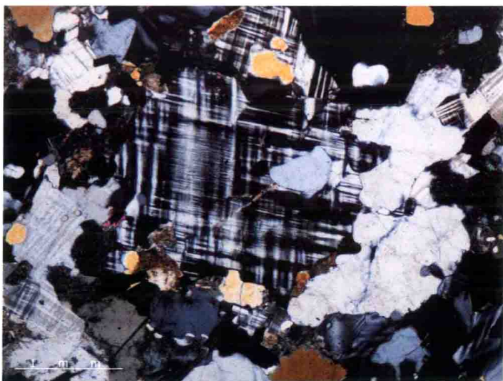
图 1-1-2 微斜花岗岩 主要成分为微斜长石,其次是石英,斜长石、暗色矿物各少量;具花岗结构,是花岗岩的偏低温相 诸暨陈蔡
