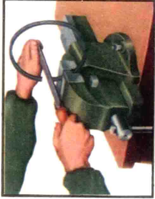
各道活塞环的闭合间隙应用锉刀修至规定尺寸，最大不应超过2毫米
