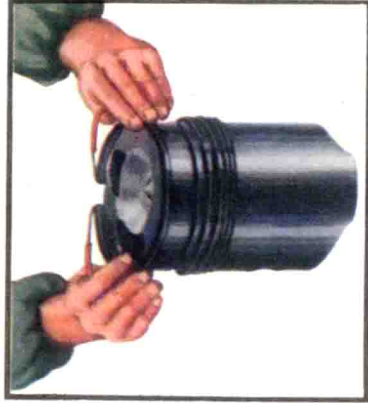
将活塞环扩张到恰能通过活塞顶部套人环槽
