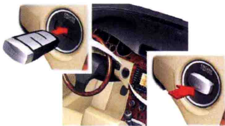
图2-7 电子点火开关操作步骤
