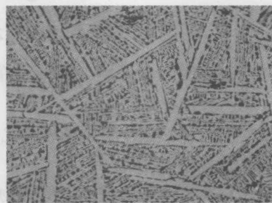
图 1-11 过共晶白口铁显微组织 (400x)
