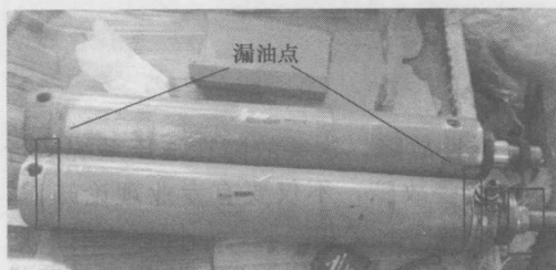
图 1-1 产生外泄漏的压力机液压缸
