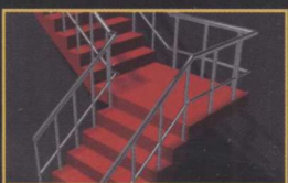
实战操作189 创建L型楼梯
