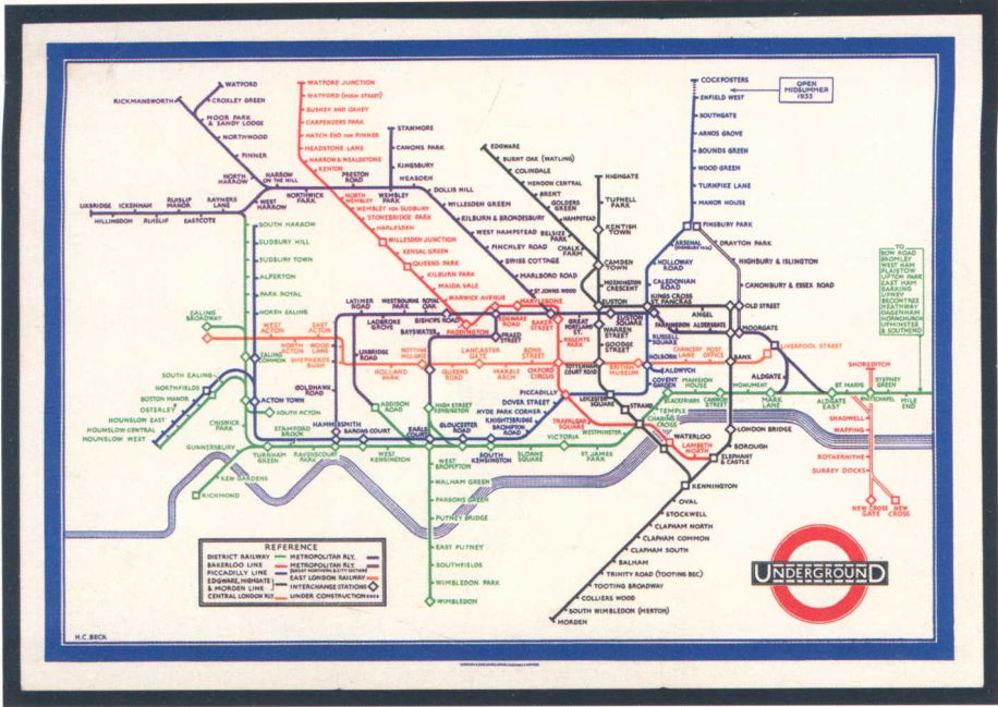
0.2（對頁）哈利·貝克，倫敦地鐵圖，1931-33。彩色平版印刷，6×9吋（15.7×22.6公分）。版權屬於倫敦交通局。 據信是以電路圖為靈感，貝克避開混亂的地勢，並把路線拉直，以替倫敦地下鐵路系統創造出一個抽象的示意圖，此圖後成為世界各地交通運輸網的一個建造樣板。
