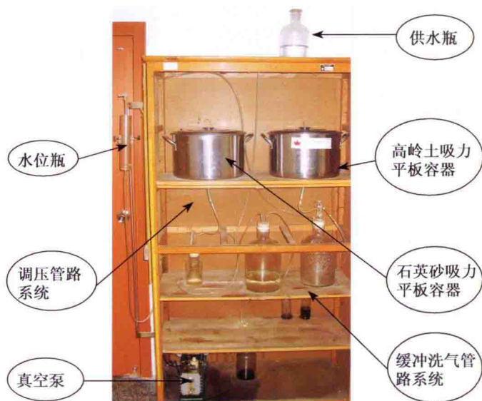
彩图 35 自制负压吸力平板装置
