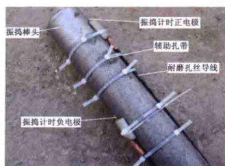
彩图 20 振捣时间采集装置(左为实物图,右为电路原理图)
