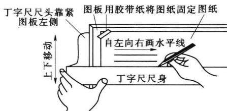
图 2-1-2 用丁字尺画水平线
