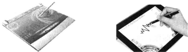
图 1-10 传统电阻式手写笔和 iPad 使用的感应式手写笔
