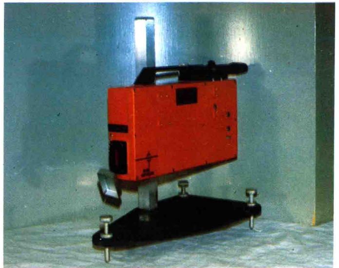
雷射在測量裝置有特殊使用價值，尤其使用於特別大或特別小的距離。 上：兩個工業雷射測量裝置。下：美國天文學家用雷射反射來測量月球到地球距離的裝置。此裝置測量距離具有高準確度。
