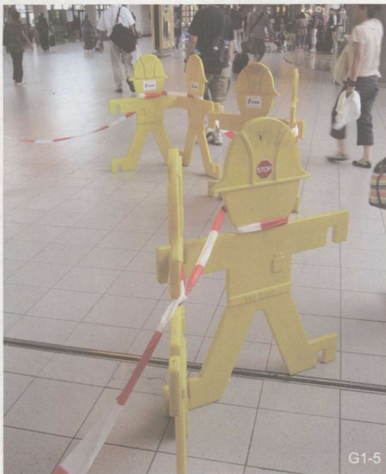
G1-5 以形态示意的形象化标识 对正在施工的场所，采用带头盔的假人模型，形成直观的形象化的施工管制标识。（荷兰·阿姆斯特丹）
