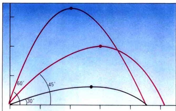
研究彈道學，主要在求得子彈離開槍口時要有一定的速度及欲獲得此速度時所需的最低膛內壓力；子彈飛行時的穩定性；彈體軌道的距離和一致性；以及子彈擊中目標時的衝擊性等。
