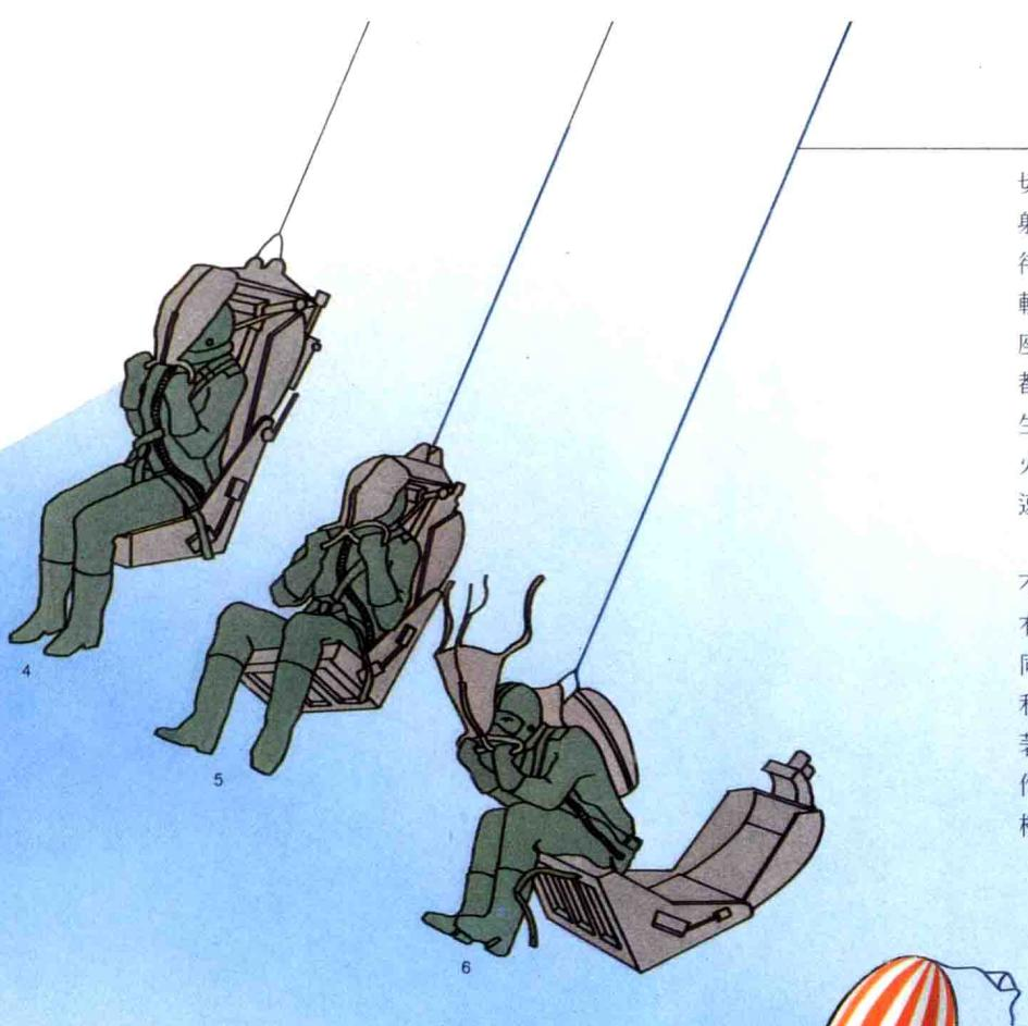
美國在第二次世界大戰後的實驗，尚包含以壓縮空氣來推進的氣體彈射系統。為了保護處於時速 480 公里以上的飛行員的面部安全，也發展出一套包括氧氣面罩、護目鏡與頭盔的裝備。但現代標準裝備中的高強度頭盔與塑膠面罩，則又更進步了。
