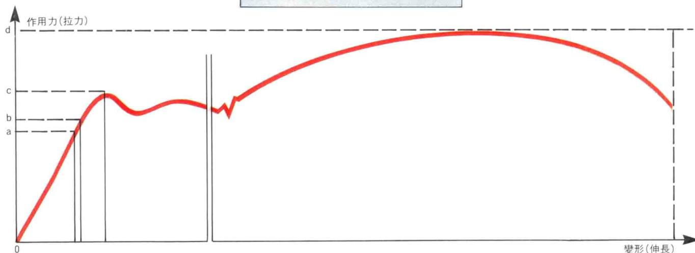
回到原來的位置，就像橡皮筋被拉長時一樣。我們稱這些物質具有高度彈性。彈性和物質變形的難易無關，而是與物質變形後回到原狀的能力有關。例如鋼鐵，雖然比橡皮不易彎曲，但却比橡皮有彈性。
