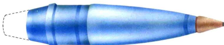
取代人力或機械能以推動發射體時，內彈道學就由此誕生了。火藥在槍枝的後膛燃燒，產生巨大的氣壓，使子彈加速通過槍管。究竟要子彈加速到多快，就要計算子彈底端所受的力。在子彈底端上的作用力，和推進劑的特性(推進劑是一種點火後立即燃燒的物質，釋放大量氣體)、燃燒火藥的量，以及燃燒後後膛到槍口間氣
