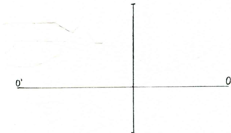
图1-2-4 用铅笔在距纸面下方2/5处绘制视平线，在纸张内右侧1/3纸宽的视平线上确定灭点O，在纸张外靠近左侧视平线上确定灭点O'。
