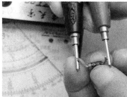
(b) 测反向电阻（交换表笔，再测两脚间的电阻）。说明：反向电阻较大，比正向电阻大几百倍，一般为几百千欧以上
