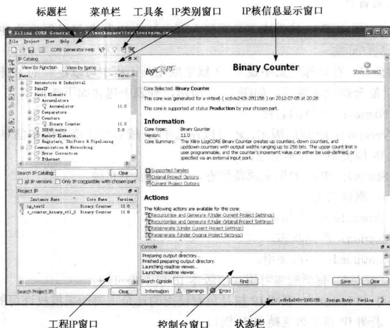
图 1.2.1 IP 核生成工具软件主界面
