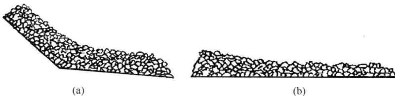
图 1-3 厚层筛分法与普通筛分法筛上料层变化图
