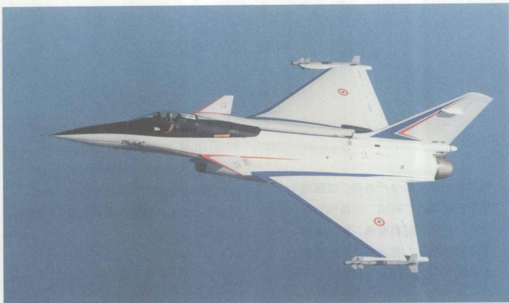
碳纤维、硼纤维和凯夫拉）、铝锂合金和最新制造工艺（如钛成分的超塑性成形及扩散结合）。在飞行测试期间飞行员座椅有30至40度的倾角，并且装备包括侧杆控制器、广角全息平视显示器（HUD）、平视显示器（这样视线就不必在HUD和仪表盘之间来回移动）和多功能彩色显示器。
