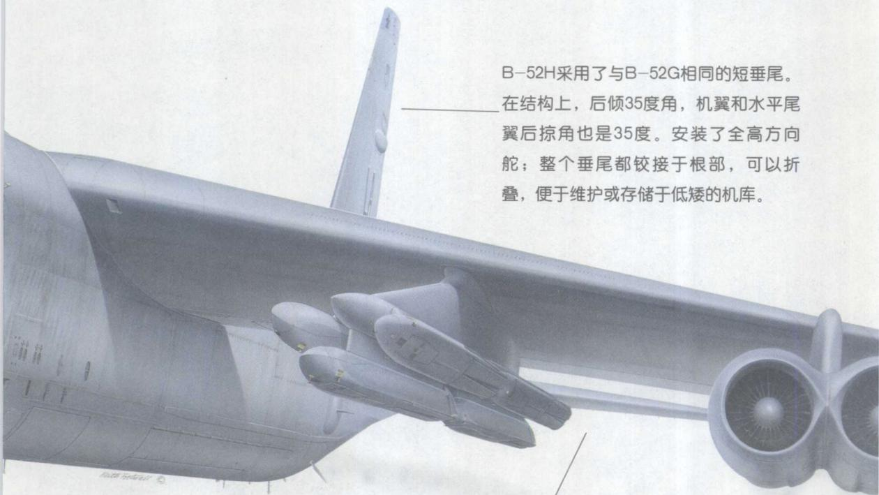
B-52H采用了与B-52G相同的短垂尾。在结构上，后倾35度角，机翼和水平尾翼后掠角也是35度。安装了全高方向舵；整个垂尾都铰接于根部，可以折叠，便于维护或存储于低矮的机库。
