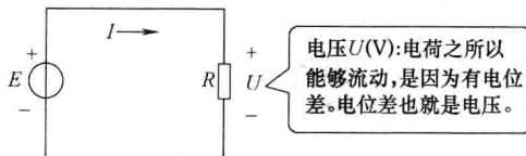
图 1-2 电路基本原理图
