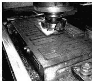
图 1-8 电磁吸盘夹具在数控加工中心的应用
