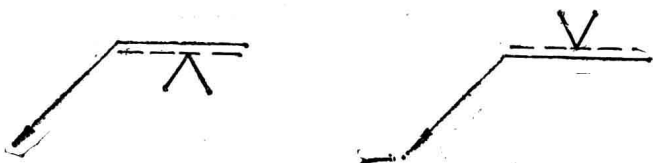
图 1—7 焊缝在接头的非箭头侧
