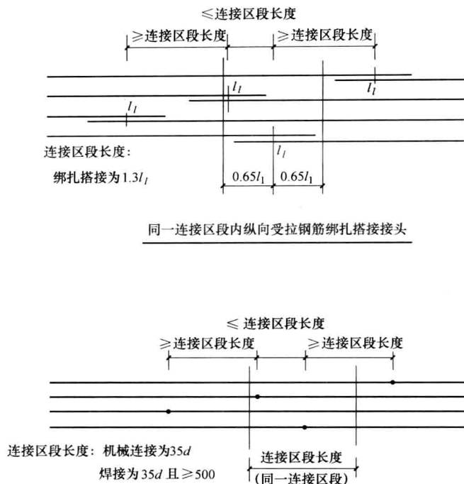
图 1-2 同一连接区段内纵向受拉钢筋机械连接、焊接接头
