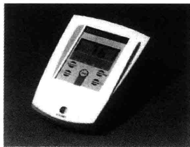
图 0-19 有光电传感器的辐照度计
