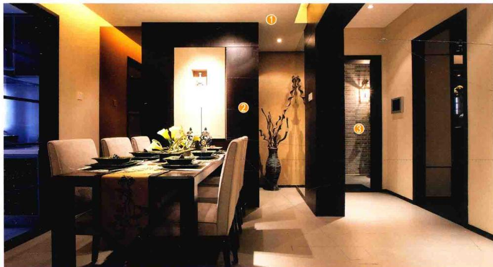
餐厅背景墙面用水泥砂浆找平, 用木工板做出凹凸造型, 部分墙面贴铁刀木饰面板后刷油漆, 剩余墙面满刮三遍腻子, 用砂纸打磨光滑, 刷底漆、面漆。
