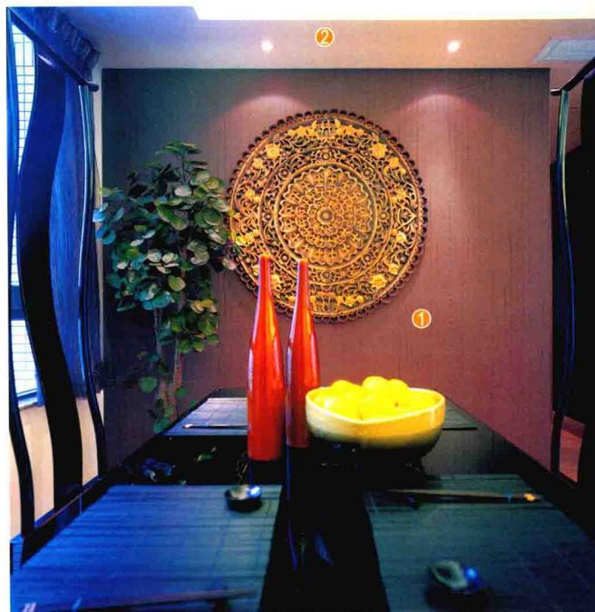
餐厅背景墙面用水泥砂浆找平，整个墙面满刮三遍腻子，用砂纸打磨光滑，刷一层基膜，用环保白乳胶配合专业壁纸粉将壁纸固定在墙面上，安装实木踢脚线。将选购的装饰挂件固定在墙面上。
