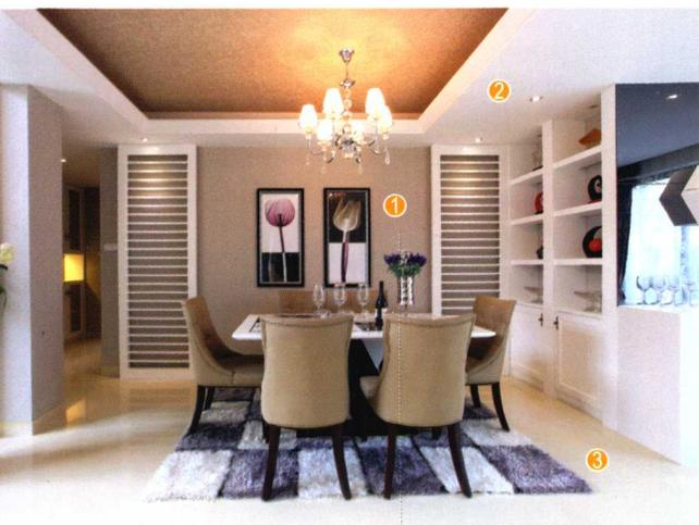
餐厅背景墙用水泥砂浆找平，整个墙面满刮三遍腻子，用砂纸打磨光滑，刷一层基膜，贴壁纸，安装踢脚线。最后将定制的通透花格板固定在地面与吊顶间。
