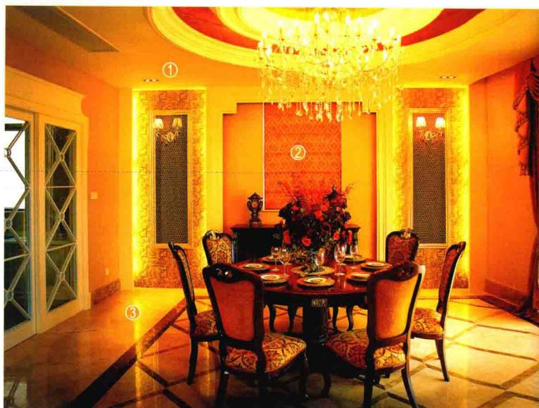
餐厅背景墙面用水泥砂浆找平，整个墙面满刮三遍腻子，用砂纸打磨光滑，刷底漆、有色面漆，安装实木踢脚线。最后将选购的艺术挂画固定在墙面上。
