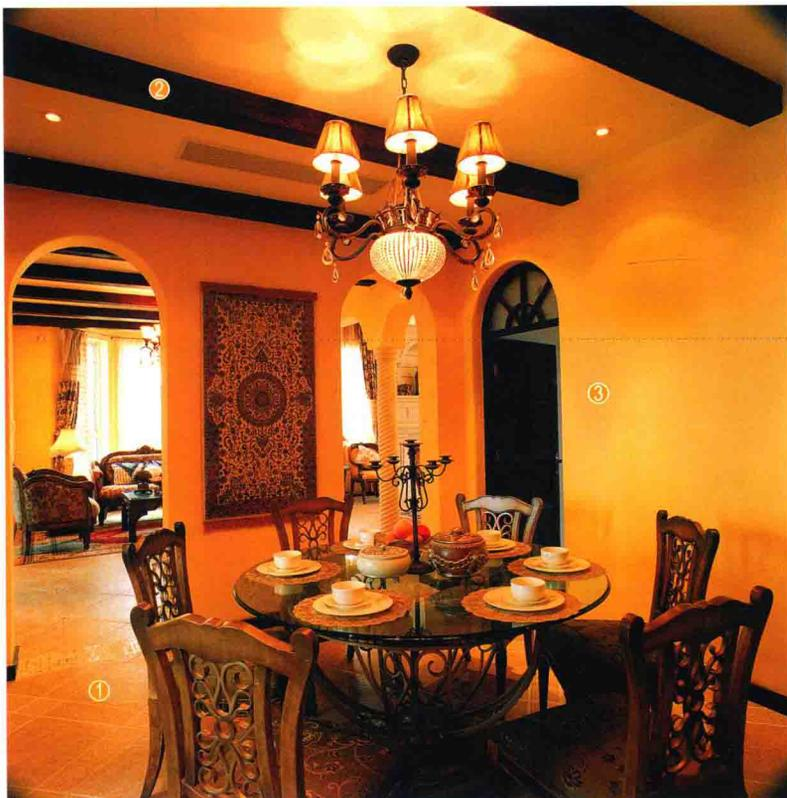
餐厅背景墙面用水泥砂浆找平，整个墙面满刮三遍腻子，用砂纸打磨光滑，刷底漆、有色面漆，最后安装踢脚线。
