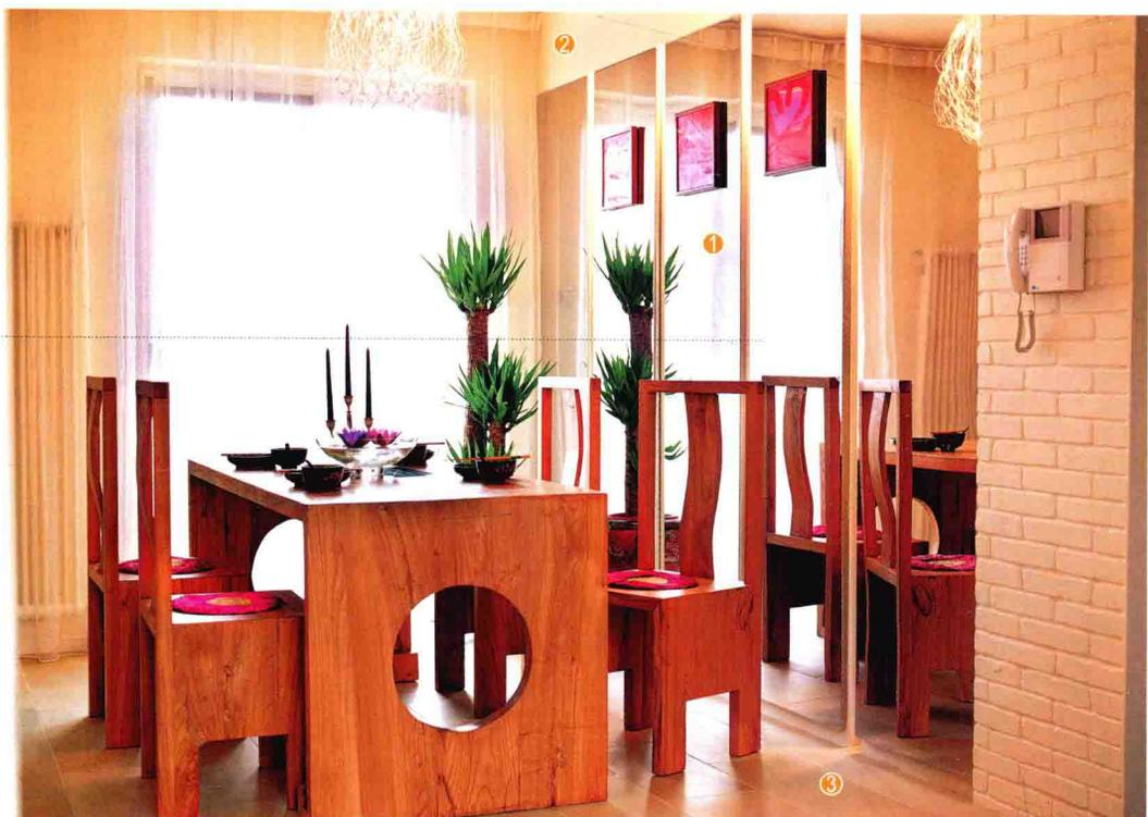
餐厅背景墙面用水泥砂浆找平，用硅酸钙板做出灯槽结构，镜子基层用木工板打底，用粘贴固定的方式固定银镜。剩余墙面满刮三遍腻子，用砂纸打磨光滑，刷底漆、面漆。
