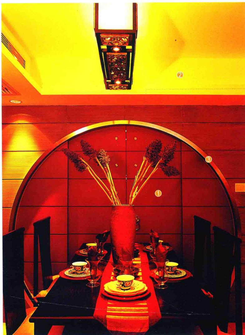
餐桌背景墙面防潮处理后用木工板打底，固定不锈钢收边线条。部分墙面贴装饰面板后刷油漆。剩余墙面用硅酸钙板离缝拼贴，满刮三遍腻子，用砂纸打磨光滑，刷底漆、面漆。
