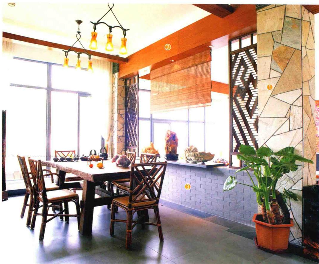
用湿贴的方式将文化石固定在餐厅背景墙面上，完工后用勾缝剂填缝。顶部用木工板打底，贴泰柚饰面板后刷油漆。固定成品隔断。
