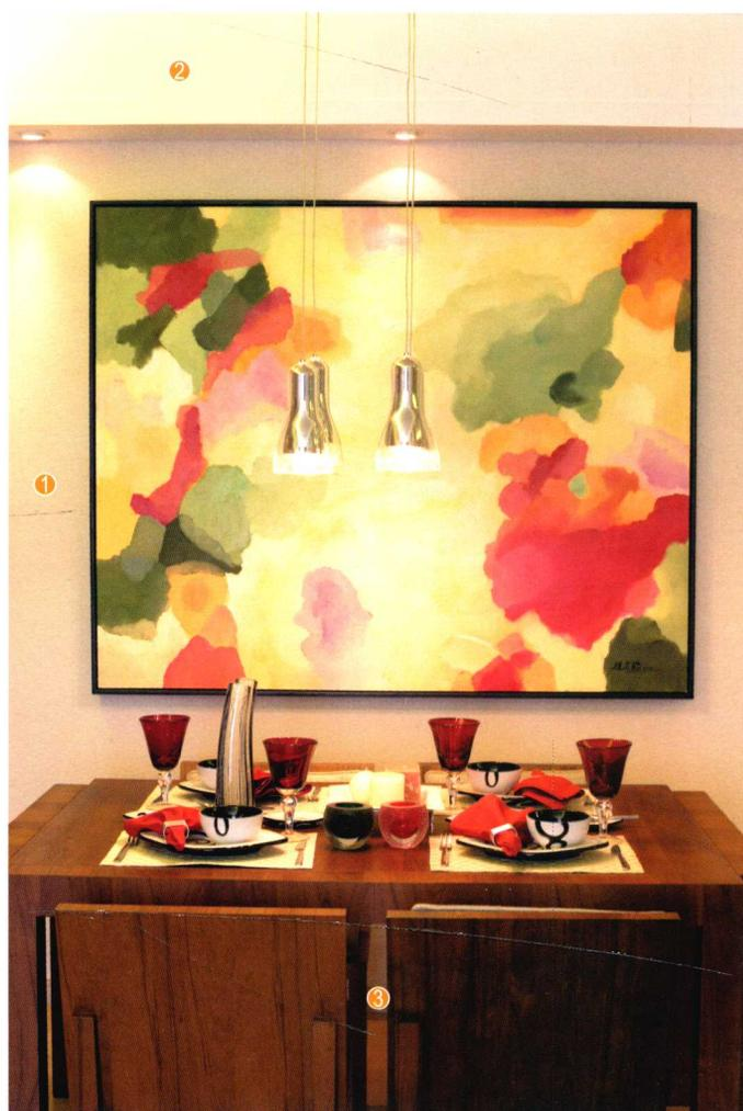
餐厅背景墙面用水泥砂浆找平，整个墙面满刮三遍腻子，用砂纸打磨光滑，刷一层基膜，用环保白乳胶配合专业壁纸粉将壁纸固定在墙面上，安装踢脚线。
