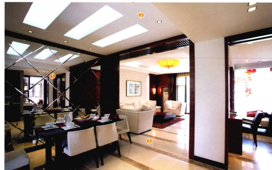
餐厅背景墙面用水泥砂浆找平，整个墙面用木工板打底，用玻璃胶将车边银镜分块固定在底板上，完工后用密封胶密封，最后将定制的实木收边线条固定在底板上。
