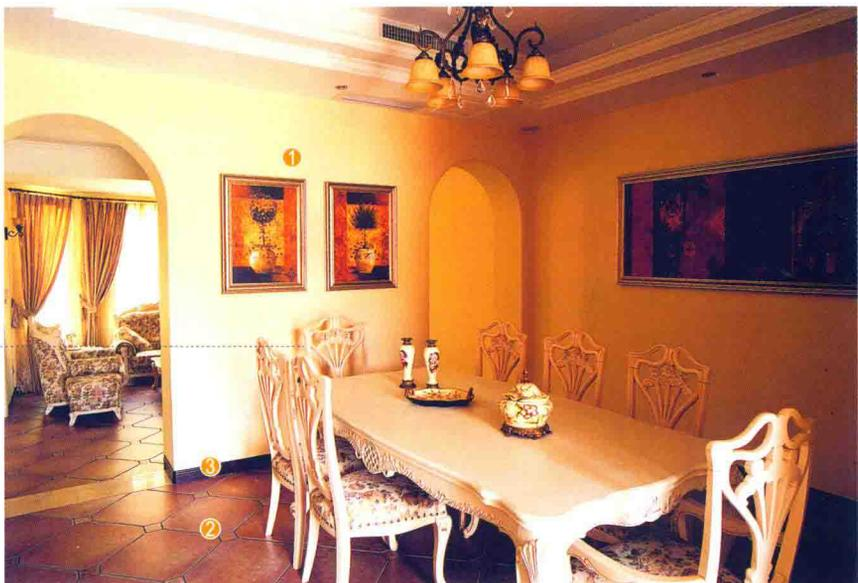
餐厅背景墙面用水泥砂浆找平, 整个墙面满刮三遍腻子, 用砂纸打磨光滑, 刷底漆、有色面漆, 最后安装踢脚线。
