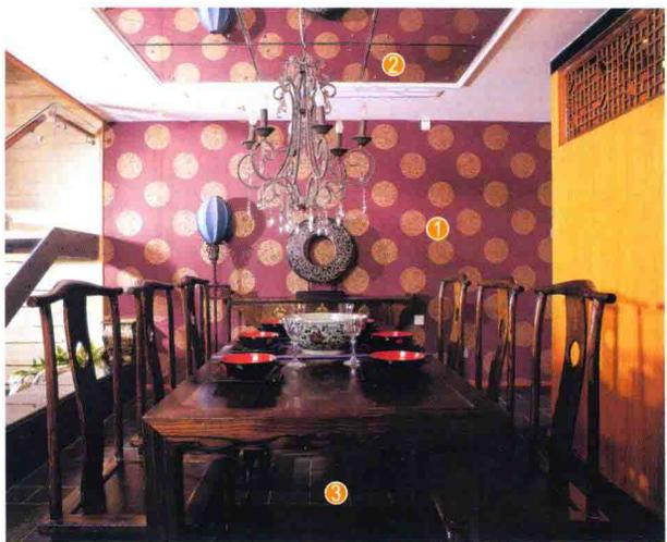
餐厅背景墙面用水泥砂浆找平, 整个墙面满刮三遍腻子, 用砂纸打磨光滑, 刷一层基膜, 用环保白乳胶配合专业壁纸粉将壁纸固定在墙面上, 最后安装踢脚线。
