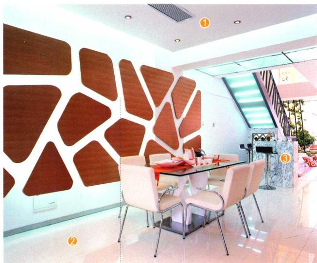
餐厅背景墙面用水泥砂浆找平，整个墙面满刮三遍腻子，用砂纸打磨光滑，刷底漆、面漆，安装踢脚线。最后固定定制成品板材。
