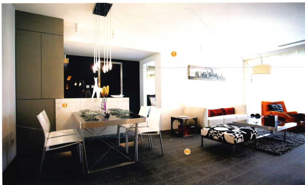
用点挂的方式将爵士白大理石固定在餐厅背景矮台上，完工后用密封胶密封。剩余墙面用木工板打底，订制的硬包固定在底板上。
