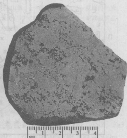
图 2-5 大庙矿区矿石标本（海绵陨铁结构）
