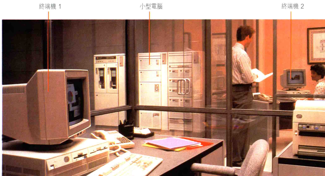
圖 1.11 這兩個終端機連接到小型電腦，使終端機可以分享硬件、軟件和數據庫資源
