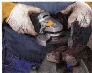
图 1-5 接下来，用纤维切割砂轮切透垫板的大部分厚度。
