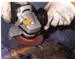
图 1-7 将剩下的多余焊缝金属磨掉，并仔细打磨焊缝使其与板条表面齐平。这就制成了用于测试的板条。
