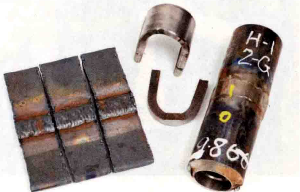
图 1-2 这是焊接认证中使用的金属板材和管件焊缝。图中左侧的坡口焊缝钢板已使用氧乙炔割炬切割成条块，以备弯曲测验之用。右侧的钢管被标注了焊接位置和焊工认证编号。中部的两块马蹄形金属件是经过弯曲测验的样件，上面的用于焊缝正面弯曲测验，而下面的用于焊缝背面弯曲测验。
