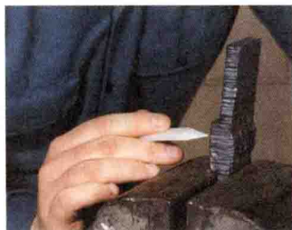
图 1-4 在这个图中，一块坡口焊缝的金属板条被夹在台虎钳上，用滑石条在垫板上做出标记。
