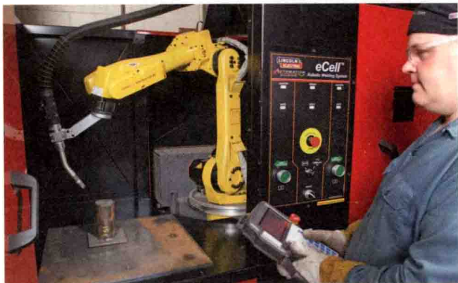
图 1-1 这是一种机器人全自动焊接系统。当大量的相同部件需要焊接时，使用这种系统非常有利。为这种系统编程并操作它的人应当具有焊接知识和技能的教育背景。焊接教育包括选择焊接方法，根据材料厚度、接头设计、焊接位置等正确设置和调整焊接设备，以及最终进行焊接质量评价等。而一个机器人是不能自行完成这些任务的。
